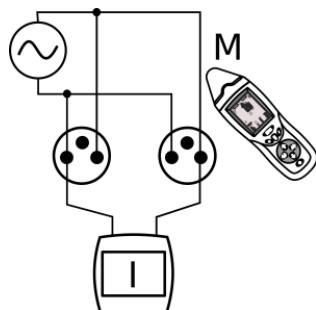
Один из выходов генератора подключается к фазному проводу для сети переменного тока или положительному для сети постоянного тока тестируемой цепи, а другой к нейтральному проводу. Существующее в этой цепи напряжение используется генератором для создания токового сигнала (макс. 40mA) в виде импульсов высокой частоты, характерным для режима «**тока**». Магнитная составляющая, созданного таким образом поля, обнаруживается приёмником.
