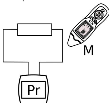
Генератор принудительно вызывает в контуре протекание тока, ограниченного сопротивлением цепи. Принимаемый сигнал пропорционален протекающему току, что позволяет значительно увеличить дальность обнаружения объекта.
