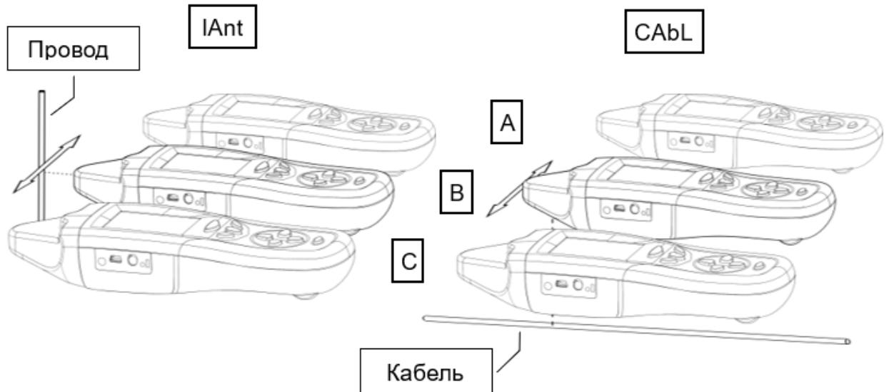
Обнаружение провода/кабеля расположенного параллельно к оси симметрии приёмника.
