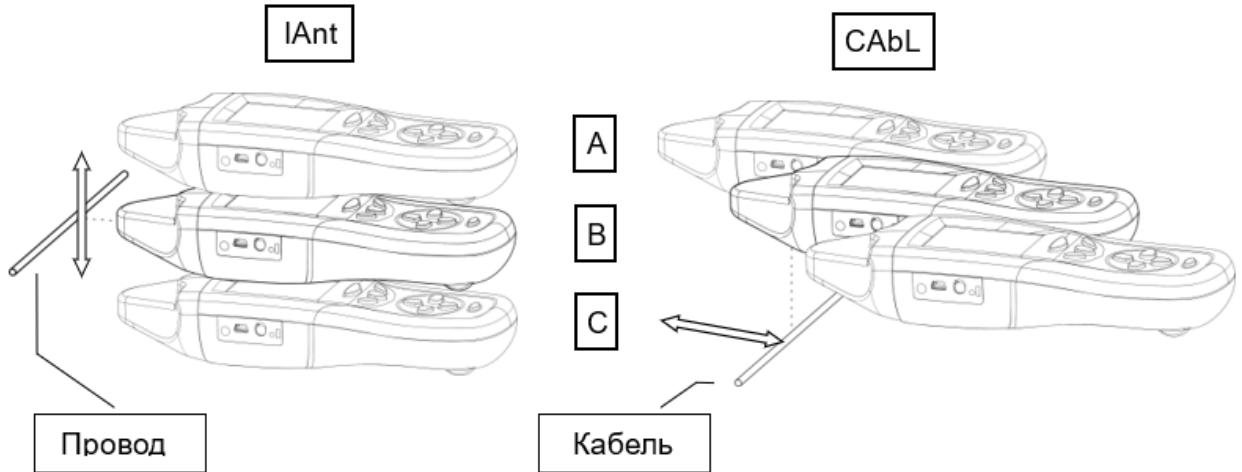
Обнаружение провода/кабеля, расположенного перпендикулярно к оси симметрии приёмника.
