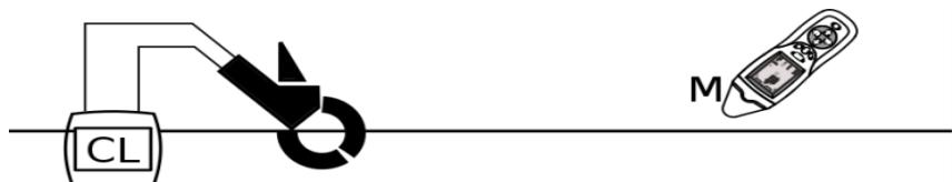
Передающие клещи применяются в замкнутых цепях, в которых может протекать переменный ток до 15A.
