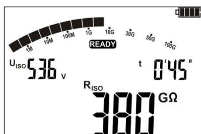
После окончания измерения на дисплее отобразится величина измерения сопротивления изоляции.
