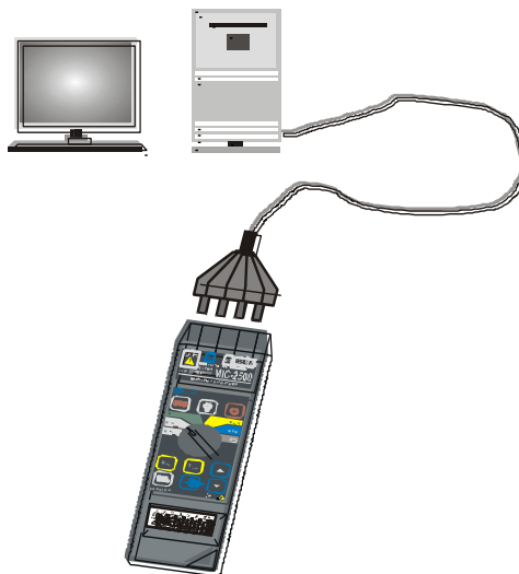
Рис. 11 Подключение разъема к прибору
