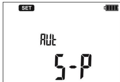
Используя клавиши  $\Delta$  и  $\nabla$ , установите тип кабеля: 3-P, 4-P, 5-P (для объектов до 1кВ) или H3-P, H4-P, H5-P (для силовых кабелей), где число обозначает количество жил в кабеле.
