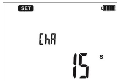
Следующее нажатие клавиши **SEL** переводит в режим установки интервалов **ChA** для временных характеристик изоляции  $R_{iso}$ . Клавишами  $\Delta$  и  $\nabla$  установите интервал времени (15, 30 или 60сек.). Горизонтальные штрихи на дисплее обозначают невозможность записи данных.
