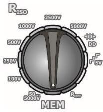
Установите поворотный переключатель выбора функций в положение **MEM** и нажмите на клавишу **MENU**.
