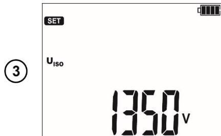
Измерительное напряжение **U<sub>ISO</sub>**.
