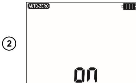
На дисплее появится надпись **AUTO-ZERO 0Ω** свидетельствующая о выполнении калибровки измерительных проводов, затем прибор переходит в режим измерения.
