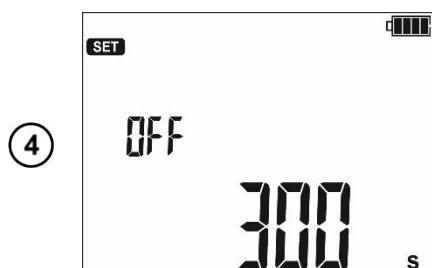
Время до автоматического выключения (300 сек., 600 сек., 900 сек.) или его отсутствие (---).
