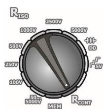
Установите поворотный переключатель выбора функций в положение **R<sub>CONT</sub>**.
