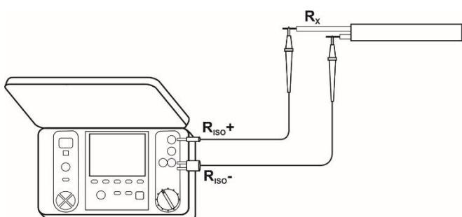
Подключите измерительные провода согласно рисунку.
