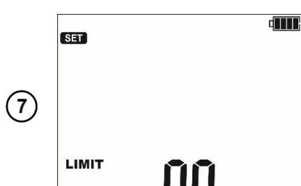
Включение (**ON**) и выключение (**OFF**) установки лимитов (только MIC-5010).
