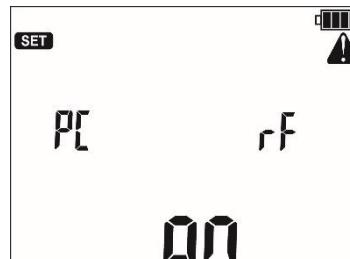
Подключите модуль OR-1 к USB разъёму персонального компьютера, нажмите клавишу **ENTER**.
