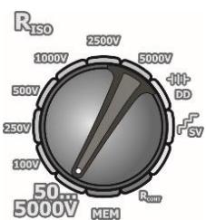
Установите поворотный переключатель режимов работы в одну из позиций **R<sub>Iso</sub>**, выберите измерительное напряжение (в положении **50...5000V** выбирается из диапазонов: 50 В...1 кВ через каждые 10 В, 1...5 кВ с шагом 25 В). Прибор находится в режиме измерения напряжения.
