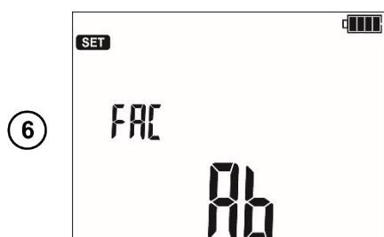
Коэффициенты абсорбции  $R_{iso}$ : Ab1, Ab2 ( $\mu$ ) или PI, DAR ( $\mu$ ).
