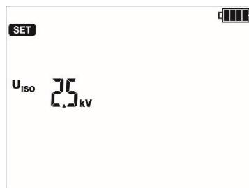
Максимальное (окончательное) измерительное напряжение:
