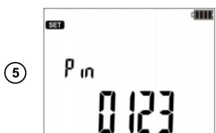
PIN-код, устанавливаемая цифра мигает. Переход к следующей цифре клавишей MENU
