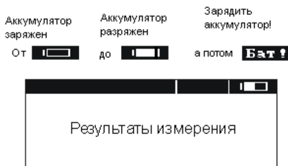
Контроль состояния зарядки аккумуляторов
