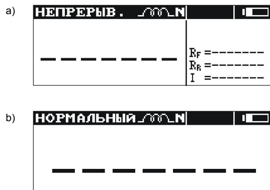
Рис.2. Вид экрана после включения измерителя (тип индуктивного объекта с нормальным временем измерения, ручное введение в память). Способ отображения: а) все результаты; б) только главный результат
