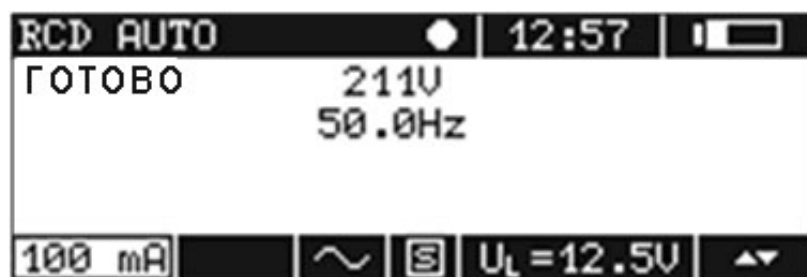
Рис.21. Отображение информации на дисплее при автоматическом измерении УЗО
