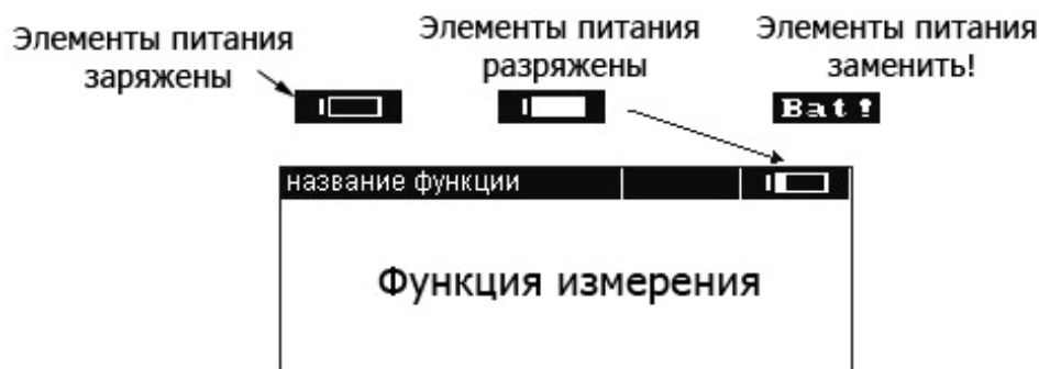
Рис. 51. Мониторинг состояния зарядки элементов питания или аккумуляторов
