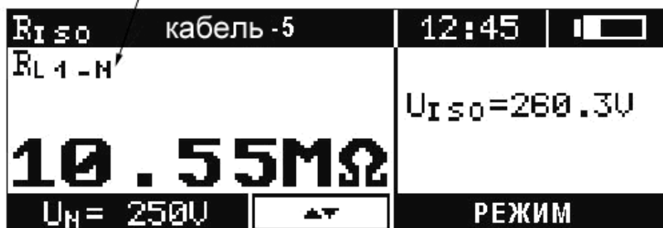
Рис.31. Отображение результатов после измерения сопротивления изоляции многожильного кабеля
