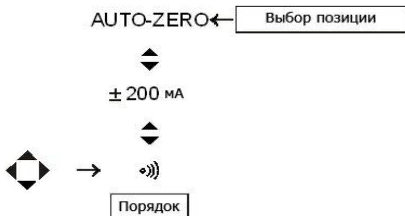
Рис.37. Установка режима компенсации сопротивления измерительных проводов
