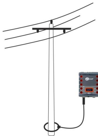
Рис.6. Работа прибора с использованием одних токовых клещей
