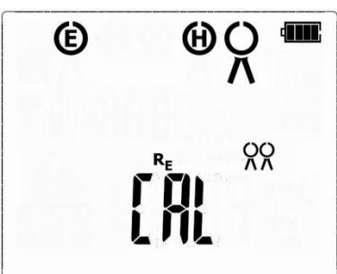
В режимах **3P+Ω** или **ΩΩ** используя клавишу **УСТ/ВЫБ** перейдите к экрану калибровки токоизмерительных клещей. Появляется мигающая надпись **CAL**, свидетельствующая о готовности к процессу калибровки.
