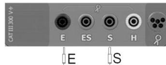
Подключить измерительные провода согласно рисунку.
