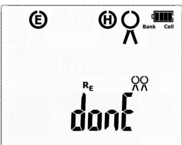
Надпись **done**, свидетельствует об окончании процесса калибровки токоизмерительных клещей. Через 20сек. прибор автоматически вернётся к экрану готовности к измерениям, или Пользователь может сделать это раньше, нажатием клавиши **СТОП/ОТМ** или **ВВОД**.
