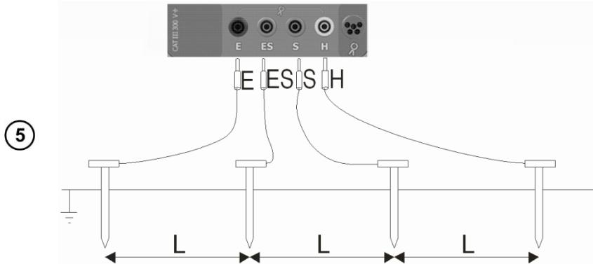
Подключить измерительные провода согласно рисунку.
