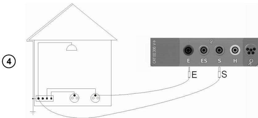
Подключите измерительные провода согласно рисунку.
