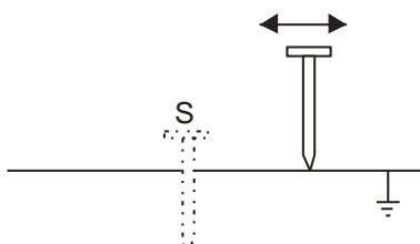
Повторите измерения несколько раз перемещая на несколько метров вдоль прямой потенциальный зонд: удаляя и приближая его к проверяемому заземлению.
