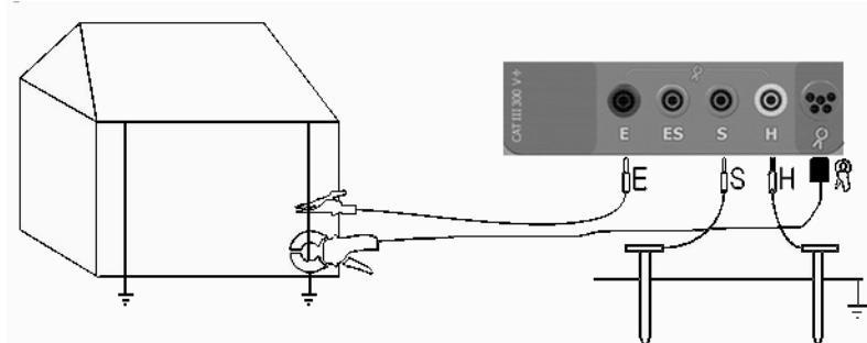
Подключить измерительные провода согласно рисунку.
