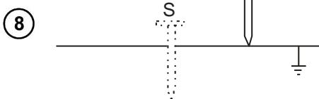
Повторите измерения несколько раз перемещая на несколько метров вдоль прямой потенциальный зонд: удаляя и приближая его к проверяемому заземлению.
