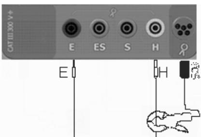
Замкните проводом разъёмы измерителя **E** и **H**, обхватите клещами этот провод. Нажмите клавишу **СТАРТ**.
