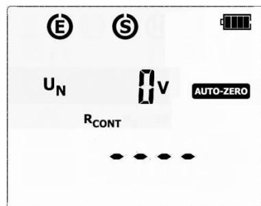
В режиме R<sub>cont</sub> используя клавишу УСТ/ВЫБ перейти к экрану автоматического обнуления сопротивления измерительных проводов **AUTO-ZERO**.
