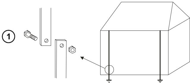
Тестируемое заземляющее устройство отсоединить от схемы заземления объекта.
