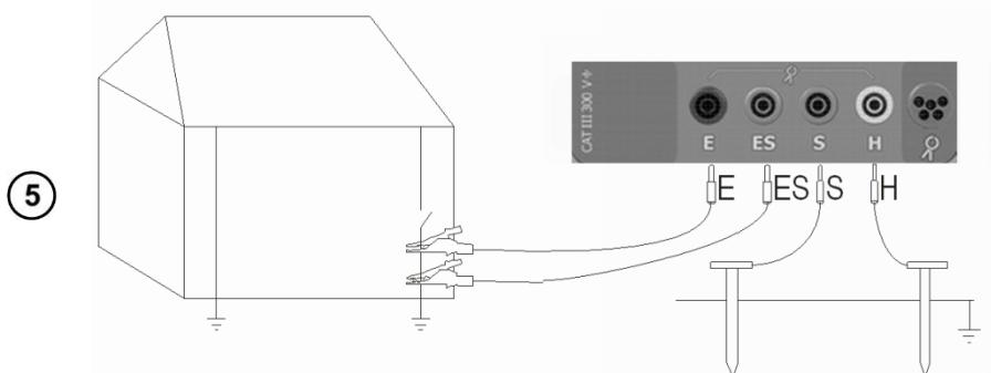
Подключить измерительные провода согласно рисунку.
