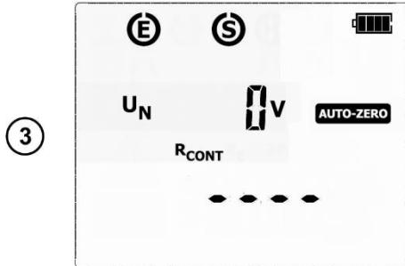
Постоянное отображение надписи **AUTO-ZERO** (не мигает), свидетельствует о выполненной калибровке измерительных проводов. В результате получено компенсированное значение с поправкой для измерения  $R_{CONT}$ . Компенсация также сохраняется после отключения и при включении измерителя (если отображается надпись **AUTO-ZERO**).
