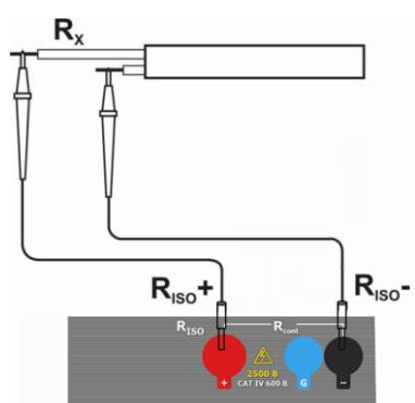
Подключите измерительные провода согласно рисунку.
