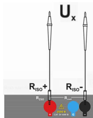
Подключить прибор к источнику напряжения.
