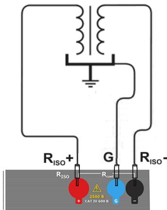
При измерении сопротивления между жилой кабеля и экраном, влияние поверхностных токов (особое влияние оказывают при сложных погодных условиях) устраниют соединением кусочка металлической фольги, навитого на изоляцию измеряемой жилы, с разъёмом **G**.
