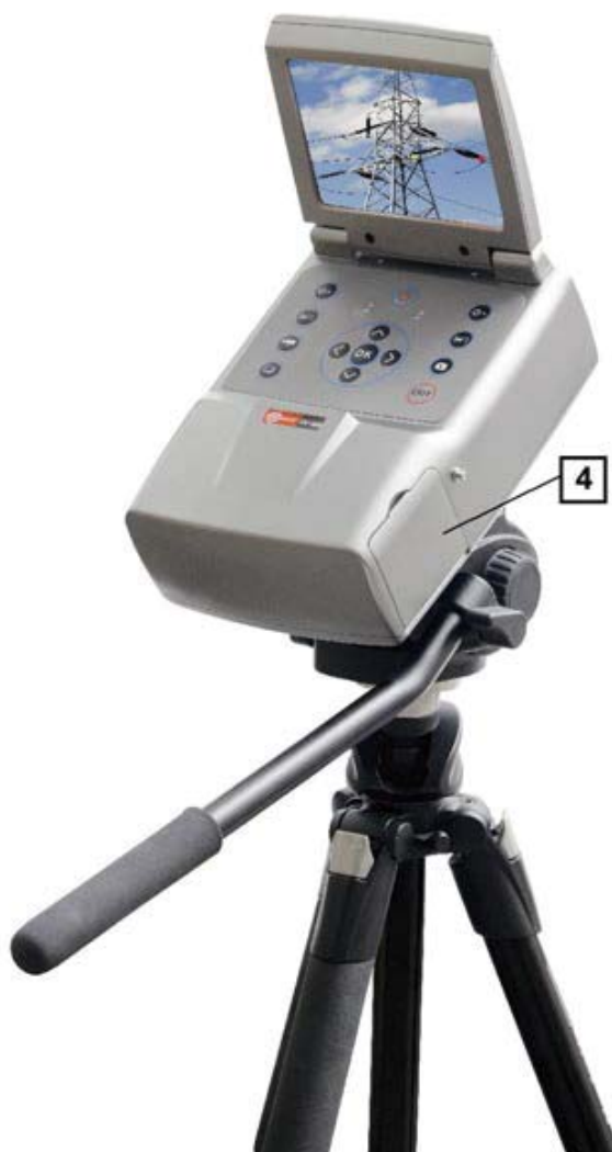
Рис. 12. Крепление UV-260 на штативе.
