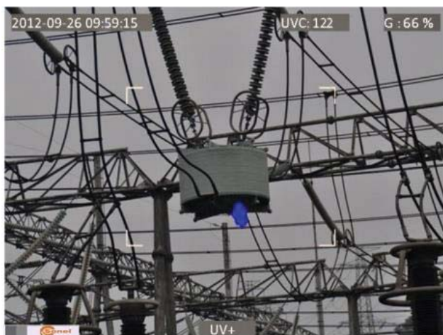
Рис. 5-8. Коронные разряды в реальных условиях электросетей
