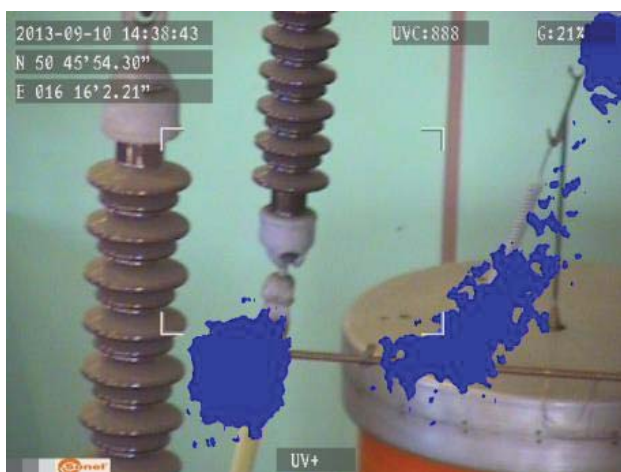
Рис. 3,4. Коронные разряды в лабораторных условиях.
