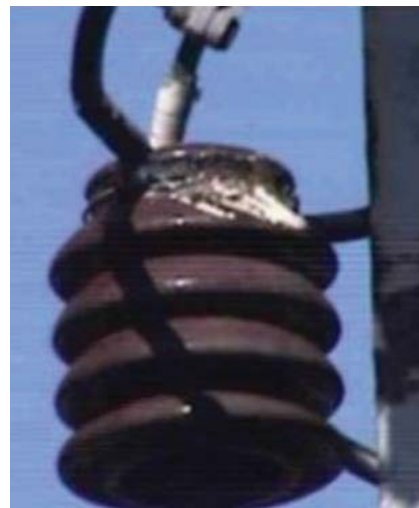
Рис. 9,10. Коронный разряд и его последствия
