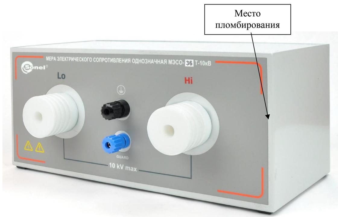
Рисунок 2 – Место пломбирования от несанкционированного доступа
