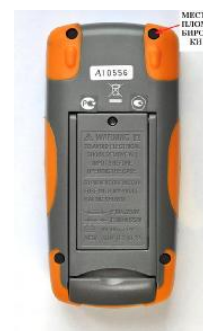
Рисунок 2 – Схема пломбировки от несанкционированного доступа.
